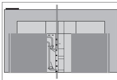
En cas d'utilisation d'un pied ou d'un support mural motorisé, assurez-vous de disposer d'une longueur de câble suffisante pour permettre au téléviseur de pivoter dans un sens comme dans l'autre ou de s'incliner avant de fixer les câbles avec les attaches prévues à cet effet pour les regrouper de manière ordonnée.
