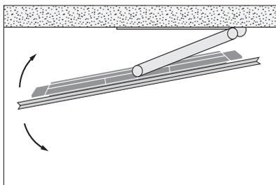
Définissez l'angle de rotation maximal du téléviseur sur le pied ou sur le support mural motorisé. Prévoyez un dégagement suffisant autour du téléviseur pour lui permettre de pivoter librement. Si votre téléviseur est monté sur le support de table motorisé, il peut être légèrement incliné pour éviter certains reflets gênants. Pour plus d'informations, voir page 22.
