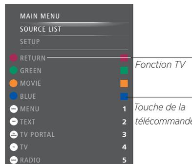
*Exemple de menu en superposition. Les touches de la BeoRemote One sont présentées à droite du menu, tandis que les fonctions qu'elles contrôlent, y compris les icônes disponibles, sont présentées à gauche. Le menu peut également indiquer des touches de la télécommande fournie avec l'équipement connecté.*
