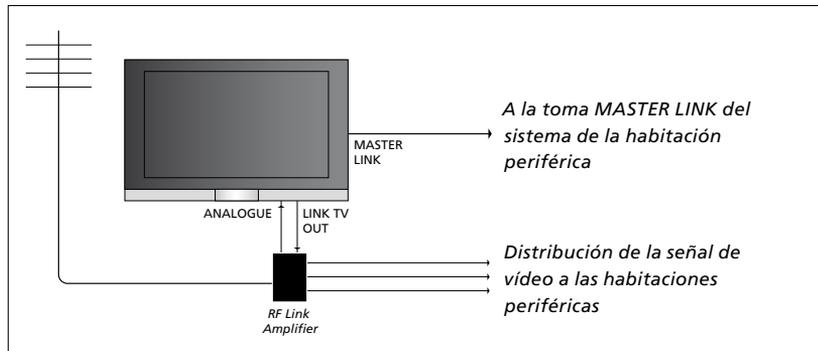
**El televisor instalado en la habitación principal debe conectarse al sistema de la habitación periférica a través de un cable Master Link:**
