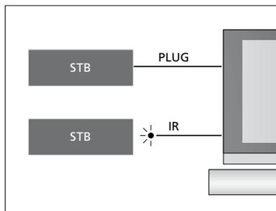
**Transmisores de infrarrojos:** Si desea usar un terminal a distancia Bang & Olufsen para controlar equipos de otros fabricantes, conecte un transmisor de infrarrojos Bang & Olufsen a cada uno de ellos. Conecte cada transmisor de infrarrojos a la toma correspondiente marcada como PUC en el panel de conexiones principal.
