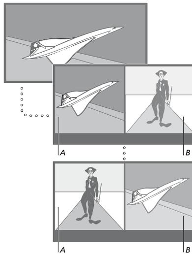
*Регулировка уровня громкости всегда производится для изображения A, хотя другие операции, такие как выбор программ, производятся для изображения B. При выборе нового источника режим двойного экрана отключается.*
