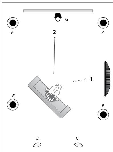
Назначение функций для подсоединенных акустических колонок позволяет вам определить функцию акустических колонок в системе объемного звучания и количество акустических колонок, которые будут использоваться. Назначение различных функций для просмотра телевизора (1) и домашнего кинотеатра (2), как показано на иллюстрации:
