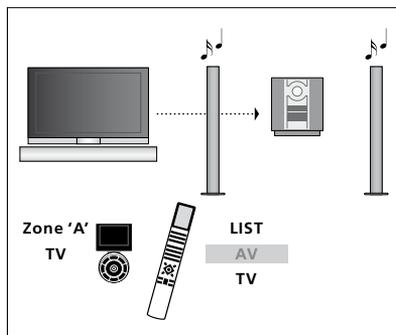
Для прослушивания звука от источника, доступного из телевизора, через акустические колонки аудиосистемы без включения экрана, выберите зону для акустических колонок аудиосистемы с пульта Веоб, затем нажмите кнопку источника, например, **TV**. (Вео4: Нажмите **LIST** и с помощью навигационной кнопки перемещайтесь вверх или вниз для вывода **AV** на дисплей Вео4, затем нажмите **TV**). Инструкция к Веоб показана слева, а инструкция к Вео4 - справа.
