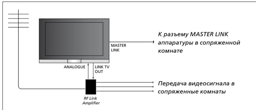
Аппаратура сопряженной комнаты должна подключаться к телевизору главной комнаты с помощью кабеля Master Link:
