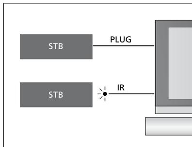
**ИК-передатчики:** Для управления аппаратурой производителей, отличных от Bang & Olufsen, с помощью пульта дистанционного управления Bang & Olufsen подключите ИК-передатчик к каждому из устройств. Вставьте каждый ИК-передатчик в соответствующий разъем с маркировкой PUC на основной коммутационной панели.
