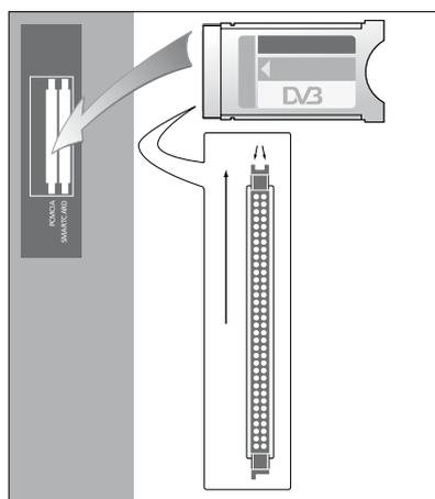
Модуль СА имеет один выступающий край на одной стороне и два выступающих края на другой стороне. Сторона с двумя краями должна быть направлена вверх.
