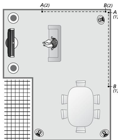
*Примеры двух возможных вариантов для точек А и В с условными линиями между ними. Вы можете настроить комбинации колонок для нескольких мест прослушивания, например, на диване перед телевизором, за обеденным столом или в кресле, где вы обычно читаете газеты.*
