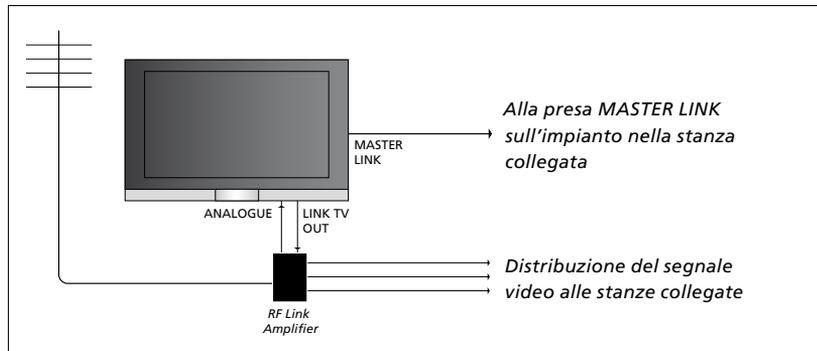
**È necessario che il televisore della stanza principale sia collegato a quello della stanza collegata mediante un cavo Master Link:**
