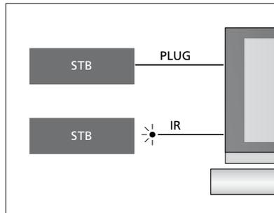
**Trasmettitori IR:** per poter controllare prodotti di altra marca con un telecomando Bang & Olufsen, è possibile montare un trasmettitore IR Bang & Olufsen su ciascun apparecchio. Collegare ciascun trasmettitore alla relativa presa PUC sul pannello di collegamento principale.
