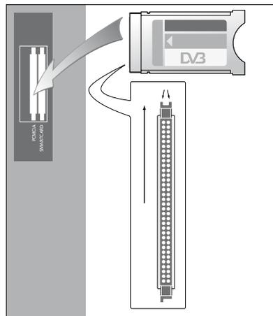
Le module CA a un bord qui dépasse d'un côté et deux qui dépassent de l'autre. Le côté avec deux bords qui dépassent doit être positionné face vers le haut.
