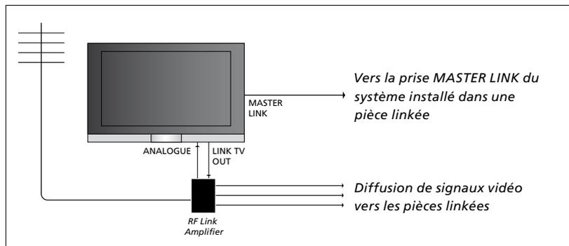
**Le système situé dans une pièce liée doit être connecté au téléviseur situé dans la pièce principale au moyen d'un câble Master Link :**
