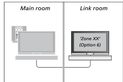
Si vous raccordez le téléviseur pour une utilisation dans une pièce liée où d'autres systèmes liés sont déjà connectés, par exemple des enceintes, vous devez alors programmer le téléviseur sur Option 5.
