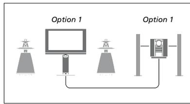
Si le téléviseur (avec ou sans enceintes supplémentaires) et un système audio (connecté à des enceintes) sont installés dans une même pièce, programmez le téléviseur sur Option 1 et le système audio sur Option 1.
