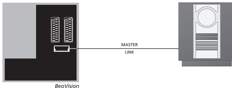
Utilizzando un cavo BeoLink, collegare le prese contrassegnate MASTER LINK sul televisore all'impianto audio.
