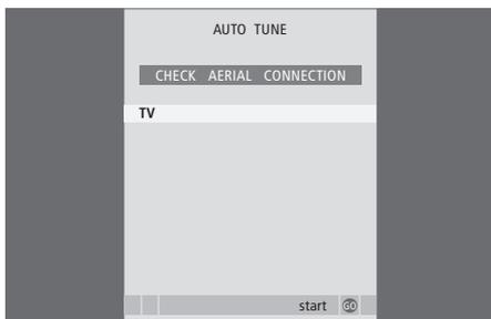
Non appena viene visualizzato il menu per la sintonizzazione automatica, viene visualizzato il messaggio CHECK AERIAL CONNECTION, che ricorda di controllare che l'antenna TV sia collegata correttamente.
