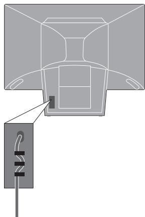
**重要事项！**由于安全原因，确保使用图中显示的缆线托架来固紧电视机的电源线。如果没有这样做，连线有可能脱离插座。
