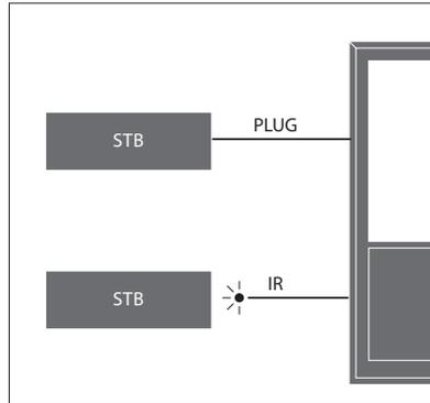
**红外发射器：**在使用 Beo4/Beo6 遥控器操作非 Bang & Olufsen 产品时，应将 Bang & Olufsen 红外线发射器安装在非 Bang & Olufsen 产品上，然后将其与连接面板上标注为 PUC 的插孔之一连接。将发射器安装在所连接设备的红外线接收器附近，以确保遥控器操作。在安装之前，请确认您能够使用 Beo4/Beo6 遥控器操作电视屏幕上的设备菜单。
