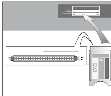
En un lado del módulo AC se aprecia una protuberancia, dos en el caso del lado opuesto. El lado con dos protuberancias debe quedar orientado hacia la derecha.
