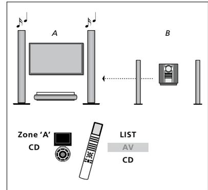
Para escuchar el sonido del sistema de audio a través de los altavoces conectados al televisor, seleccione la zona correspondiente a dichos altavoces en Beo6 y pulse el botón de una fuente de audio (como, por ejemplo, CD). (Beo4: Pulse LIST y presione el botón de navegación hacia arriba o hacia abajo hasta que se muestre la opción AV en el visor de Beo4; a continuación, pulse CD). Las instrucciones para Beo6 se muestran a la izquierda; las instrucciones para Beo4 se muestran a la derecha.
