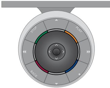
Si controla el televisor con un terminal a distancia Beo6, presione el botón central hacia arriba, hacia abajo, hacia la izquierda o hacia la derecha para desplazarse por los menús. Púlselo hacia dentro para confirmar opciones y parámetros en los menús.
