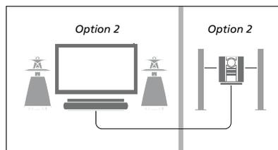
*Si el sistema de audio está instalado en una habitación y el televisor (con o sin altavoces complementarios) está instalado en otra, configure el televisor en la opción 2 y el sistema de audio en la opción 2.*
