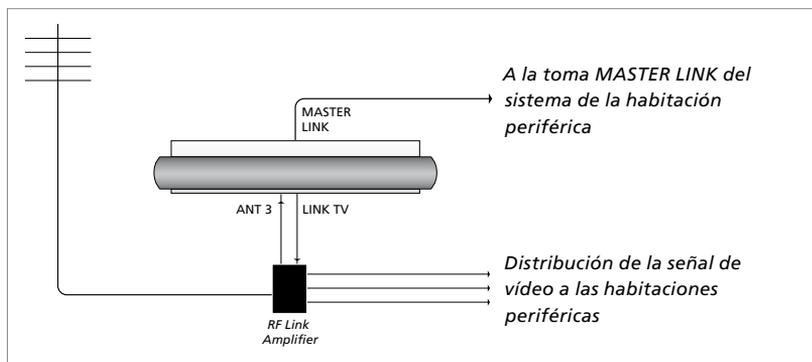
**El televisor instalado en la habitación principal debe conectarse al sistema de la habitación periférica a través de un cable Master Link:**
