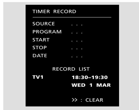
Das Timer-Aufnahmemenü. Eine Timer-Aufnahmeprogrammierung wird für TV-Programm Nummer 1 abgespeichert, Startzeit 18.30 Uhr am Mittwoch den 1. März.
