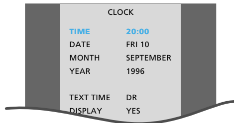
Menú para el ajuste del reloj. El punto TEXT TIME indica la sincronización con el teletexto. El punto DISPLAY indica si el reloj será visualizado en el display del BeoCenter AV5 o no
