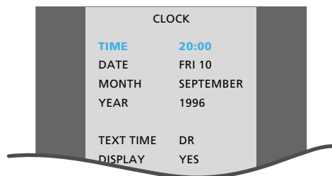
Menü für die Einstellung der Uhrzeit – der Punkt TEXT TIME zeigt die Synchronisierung mit Tele/Videotext an. Der Punkt DISPLAY zeigt an, ob die Uhrzeit auf dem BeoCenter AV5-Display angezeigt wird
