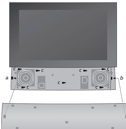
**Instalación de la cubierta del altavoz:** Sujete la cubierta del altavoz ligeramente a la derecha de los "soportes" a y b. A continuación, deslice la cubierta hacia la izquierda para que los "puntos de sujeción" se acoplen en los "soportes" correspondientes (a, b y c) del televisor.
