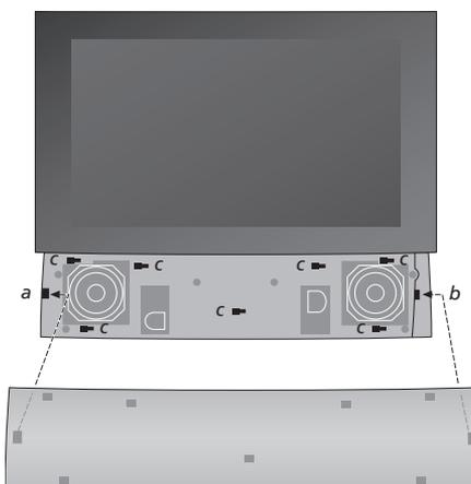
**Prender a cobertura das colunas:** Mantenha a cobertura da coluna ligeiramente levantada para a direita dos "suportes" a e b. Agora, deslize a cobertura para a esquerda para os "pontos de fixação" engatarem nos "suportes" correspondentes (a, b e c) no televisor.
