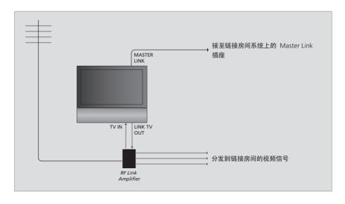
主房间系统和所连接房间的系统的连接必须使用 Master Link 电缆·
