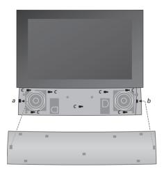
安装扬声器护盖: 提起扬声器护盖, 稍微朝"托架"a 和 b 的右侧靠。
