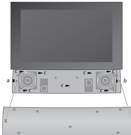
**Instalación de la cubierta del altavoz:** Sujete la cubierta del altavoz ligeramente a la derecha de los "soportes" a y b. Deslice la cubierta hacia la izquierda para que los "puntos de sujeción" se acoplen en los "soportes" correspondientes (a, b y c) del televisor.
