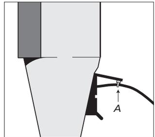
Por razões de segurança, deve apertar o cabo da rede eléctrica à tampa preta utilizando para isso a braçadeira de cabos fornecida (A).
