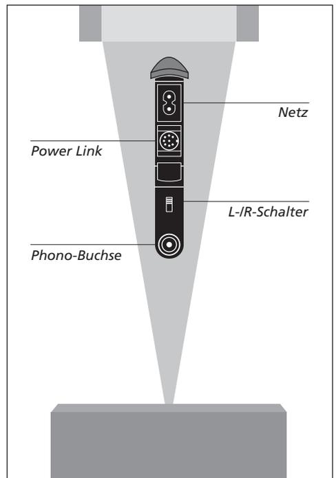
*Beachten Sie: Die Typennummer der BeoLab 8000 Lautsprecher-Box ist auf dem auf der Innenseite der Buchsenfeld-Abdeckung aufgeklebten Label angegeben.*
