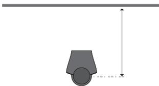
**スピーカーとの距離の測り方：**スピーカーと壁の距離を測る際は、この図を参考にしてください。スピーカーを上から見た図です。
