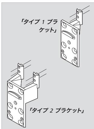
**BeoLab 7-4 ブラケット：**スピーカーの取付けには、このページに示しているブラケット以外は使用しないでください。Bang & Olufsen 製の適切なスタンドまたは壁掛けブラケットに取り付けてください。
