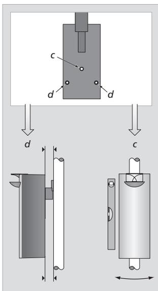
**調整:** ネジ 2 本 (d) を使って、スピーカーとスタンド/ウォールブラケットの位置を合わせます。スピーカーの両端が垂直になっていることを確かめてから、ネジ (c) を締め付けます。
