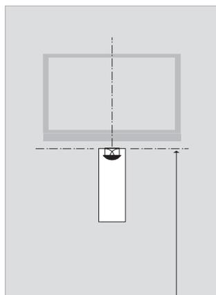
**スピーカーの配置：**スピーカーは、スクリーン下の真ん中の位置に取り付けます。スピーカーは、必ず垂直に配置してください。
