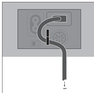
电缆夹：为安全起见，来自墙上插座的电源线必须紧固到扬声器上。若要完成这项动作，请将电源线拉到电缆夹后面。
