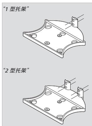
**BeoLab 7 托架：**务必将扬声器紧固到下列任何一款托架以及适当的 Bang & Olufsen 脚架或墙上托架。
