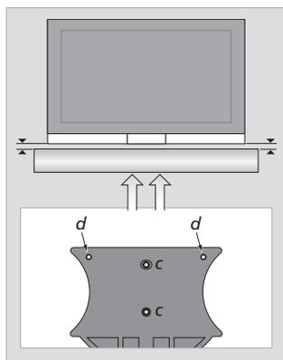
**调整:** 首先, 将安装在脚架或挂墙托架上的电视机调到适当的高度! 接着透过两颗螺丝钉 (d) 调整扬声器, 使它与电视机的底端平行。使扬声器前方与电视机对齐, 然后旋紧两颗螺丝钉 (c)。
