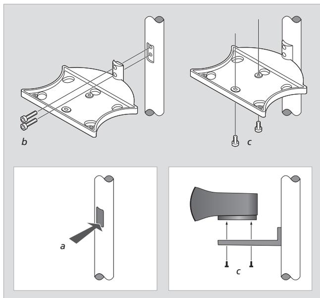
In questa pagina è mostrato in che modo fissare il diffusore a un supporto BeoVision 7\* o staffa a parete. Per utilizzare il diffusore con un altro impianto Bang & Olufsen, vedere la guida fornita con l'impianto.
