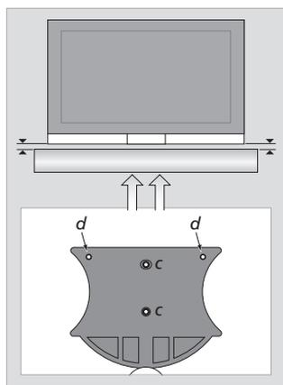
**Regolazioni:** per prima cosa, assicurarsi che il televisore sia in posizione piana sullo stand o sulla staffa a parete. Quindi, utilizzare le due viti (d) per regolare il diffusore in modo che si trovi parallelo al lato inferiore del televisore. Allineare quindi la parte anteriore del diffusore al televisore e serrare le due viti (c).
