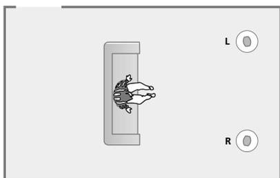
**Пример 1:** Акустические колонки установлены в одном конце комнаты (но не у стены) и не вблизи боковых стен. Следовательно, переключатель Speaker Position должен устанавливаться в позицию FREESTANDING на обеих лево- и правосторонней колонках.
