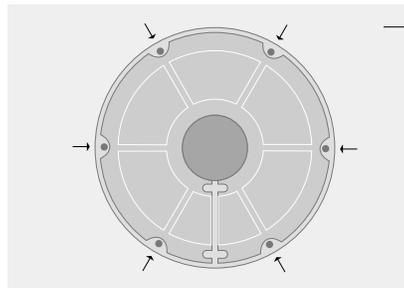
**Регулировка резиновых ножек:** Для компенсации неровных участков поверхности пола на подставке BeoLab 1 предусмотрены шесть регулируемых резиновых ножек (указаны стрелками на иллюстрации). Отрегулируйте их по мере необходимости, предварительно установив акустическую колонку в выбранное положение.
