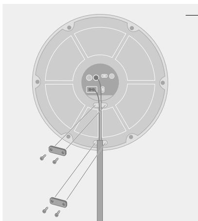
**Кабельные зажимы:** В целях безопасности Вы *обязаны* закрепить кабели и кабелепровод двумя зажимами, как показано на иллюстрации.
