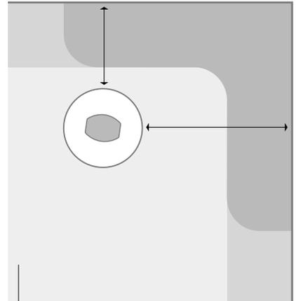
**Как проводить измерения?** Оба расстояния измеряются от края подставки BeoLab 1, которая установлена в ближайшем к стене положении (зона вдоль стен комнаты приблизительно равна ширине подставки BeoLab 1).
