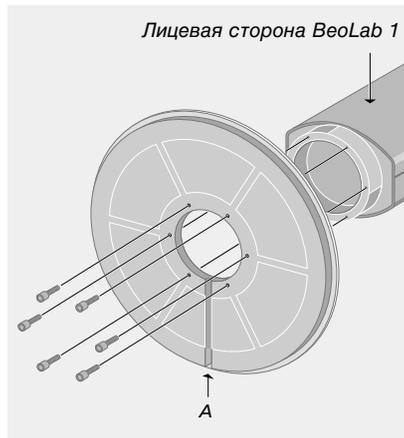
**Сборка:** Уложив BeoLab в упаковке в горизонтальном положении, поднимите нижнюю сторону колонки и подложите под нее дополнительный блок упаковочного материала. Закрепите подставку в предусмотренном положении. Канавка для кабелей должна быть направлена вниз (A), и направляющий штифт подставки входит в соответствующее отверстие в нижней части колонки. Закрепите подставку предусмотренными шестью винтами.
