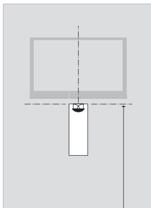
**Colocação:** A coluna tem que ser colocada centrada por baixo do ecrã. Coloque sempre a coluna na vertical!
