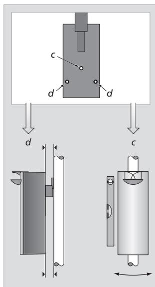
**Ajustes:** Use os dois parafusos (d) para alinhar a coluna com o suporte de chão ou de parede. A seguir posicione a coluna de forma a que a parte lateral esteja na vertical, e, por fim, aperte o parafuso (c).
