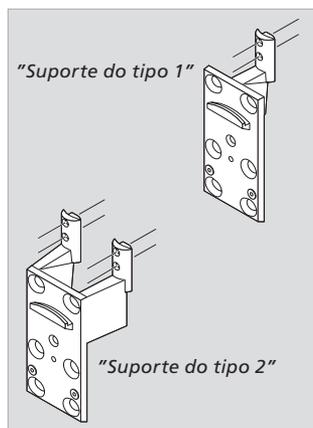
**Suportes da BeoLab 7-4:** A coluna deve ser fixa a um dos suportes mostrados aqui, e num suporte de chão ou de parede adequado da Bang & Olufsen.
