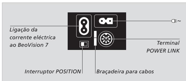
O painel de terminais está localizado na parte de trás da coluna.
