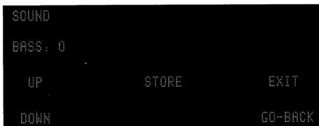
*UP/DOWN... Augmente ou diminue les niveaux de basses ou d'aigus. Ces niveaux peuvent être ajustés de 6 échelons vers le haut ou vers le bas. 0 correspond à la position neutre.*
