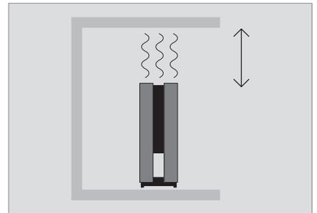
為了確保良好的通風，請在插座設備側面留下至少5釐米（2英寸）空間，並在上方留下10釐米（4英寸）空間。任何情況下，插座設備均不能覆蓋有絕緣材料之類的東西。
