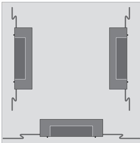
您可以水平或垂直固定插座設備。注意，牆托架的鎖緊機構要求在水平安裝插座設備時使插座面向下方。
