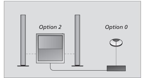
音頻/視頻系統。當音樂系統是獨立設置或與視頻系統連接，且有揚聲器連接到視頻系統時，視頻系統接管了《BeoCenter 2 指南》提及的部分功能，例如設置定時器。
