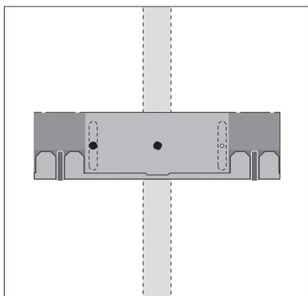
水平位置：個中一個螺釘必須是方頭螺釘（4毫米—埋頭/#8—5/32"），該螺釘透過石膏，並且至少有15毫米（5/8"）鑽入一個立柱中。為確保穩固，在另外的一個孔中必須使用至少一種專用於石膏板的螺釘。
