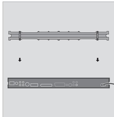
電源線：為確保安全，必須安裝蓋子。電源線穿過插座設備各端的開口並且安裝好蓋子後，防止電源線被意外扯掉。
