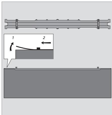
插座蓋：若要接觸到插座，必須拆下插座蓋。提起插座蓋的一端，側向滑動插座蓋並使其脫離。必須將線纜穿過插座設備各端的開口。
