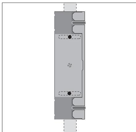
垂直位置：使用兩個方頭螺釘（4毫米—埋頭/#8—5/32"），這些螺釘透過石膏，並且至少有15毫米（5/8"）鑽入一個立柱中。
