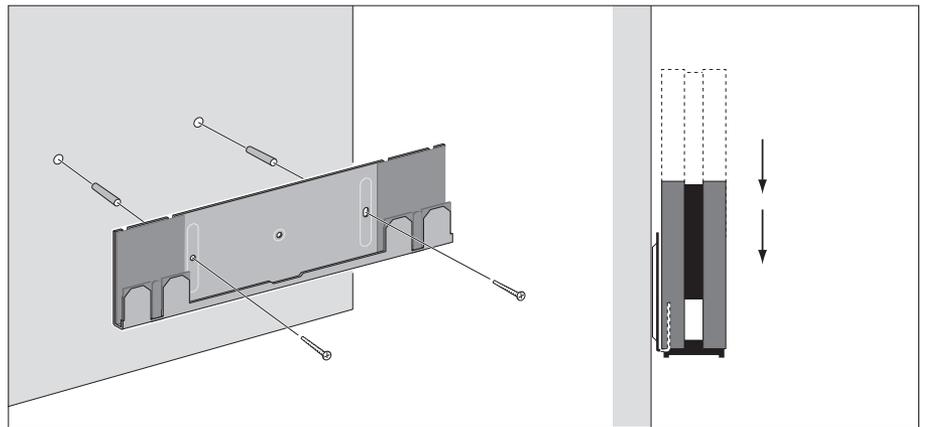
安裝牆托架：必須使用每個具有最小額定載荷6千克（13磅）的兩個螺釘或緊固件。
