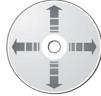
處理光碟：清潔光碟時，沿直線從光碟中心到邊緣擦拭光碟。
