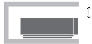
*Achten Sie bei der Aufstellung des Festplattenrecorders auf Abstände für ausreichende Lüftung.*
