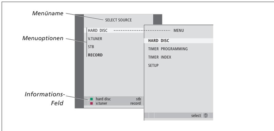
Das erste Menü im Menüsystem ist das QUELLENWAHL-Menü. Von hier aus können Sie das Hauptmenü aufrufen, V.TUNER (den im Festplattenrecorder integrierten TV-Tuner) aktivieren, eine angeschlossene Set-top Box bzw. einen DVD-Player einschalten sowie eine Aufnahme starten bzw. stoppen.
