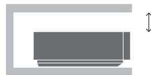
*Au moment de mettre en place l'enregistreur à disque dur, laissez suffisamment d'espace pour la ventilation adéquate.*
