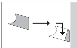
Faça deslizar o suporte de parede no apoio até encaixar.
