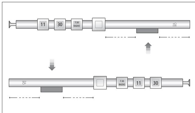
Coloque o relógio despertador no suporte de parede, tal como indicado. É importante que o suporte segure o relógio de parede pelo "lado da pilha" – de modo a que o íman integrado exerça o poder de fixação.
