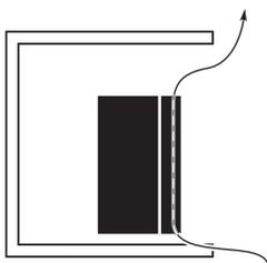
*Sistamate la cassetta di amplificazione su una superficie stabile, per es. su un punto del pavimento senza moquette o tappeti, o su un ripiano oppure sul fondo di un armadio. Lasciate uno spazio libero di circa 5 cm sopra la cassetta per permetterne la ventilazione.*
