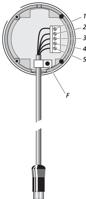
Collegate i conduttori del cavo ai terminali all'interno del ricevitore nel seguente ordine:
