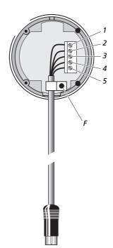
Connectez dans cet ordre les fils du câble aux vis situées à l'intérieur du récepteur :
