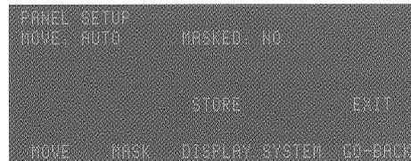
*MOVE:AUTO... Wenn die Beolink 7000 auf einer flachen Unterlage platziert ist, hebt sie sich automatisch in die angewinkelte Bedienungsfeld-Position.
