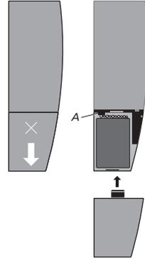
若將手持話機內的電池更換為新電池，請按照新電池的附帶說明進行操作。只能使用從 Bang & Olufsen 零售商處購得的原裝電池！
