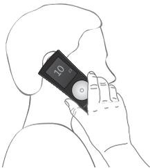
El teléfono dispone de un diseño 'invertido', según el cual el micrófono y el altavoz se encuentran en la cara opuesta a la pantalla.
