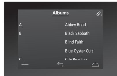
以無線方式操作產品時，右上方會出現訊號強度指示條。至少需顯示2條訊號強度指示條，以確保能正常操作。
