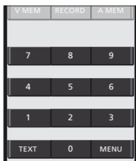
**Tasti numerici ...** i tasti 0-9 sono utilizzati quando è necessario digitare numeri, per esempio per selezionare un programma TV o radio, le pagine del televideo, brani specifici di un CD o DVD o una particolare registrazione audio o video.
